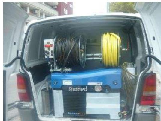
2. Odštopavanje, čišćenje i ispiranje kanalizacijskih i odvodnih cijevi visokotlačnim uređajem MINI JET koristi se unutar objekta za odvodne instalacije.
